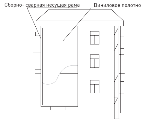
Схема расположения поддерживающих конструкций светокороба
